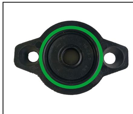
Asegúrate de aplicar la silicona SOLO en el área marcada con un círculo verde en la imagen de arriba.
